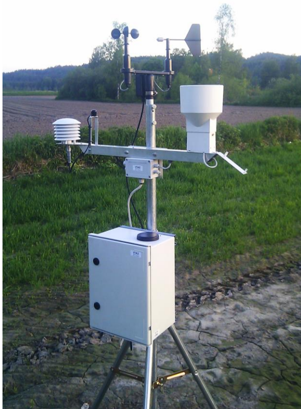
Bildet viser klimastasjon etablert ved GRID felle nr 16 (se under). Stasjonen logget temperatur, nedbør, luftfuktighet, innstråling, vindretning og vindstyrke. Foto: L.-A. Høgetveit
